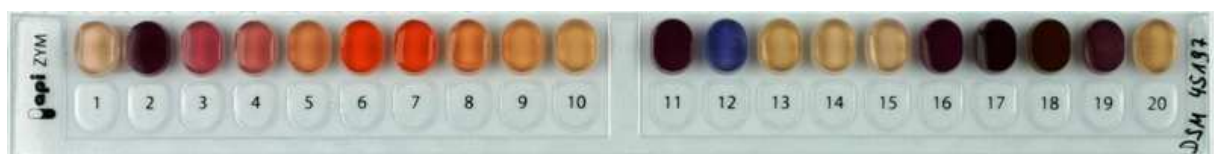
Abbildung 2: Apizym-Teststreifen mit Keim DSM 45197.
